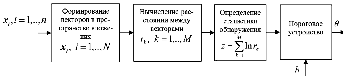
Рис. 1. Функциональная схема фрактального обнаружителя радиосигналов
