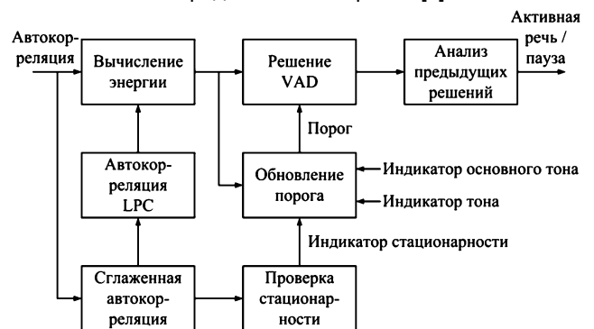
Рис. 4. Алгоритм VAD кодера GSM-EFR
