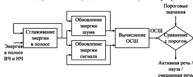
Рис. 7. Алгоритм RDA кодера IS-127
